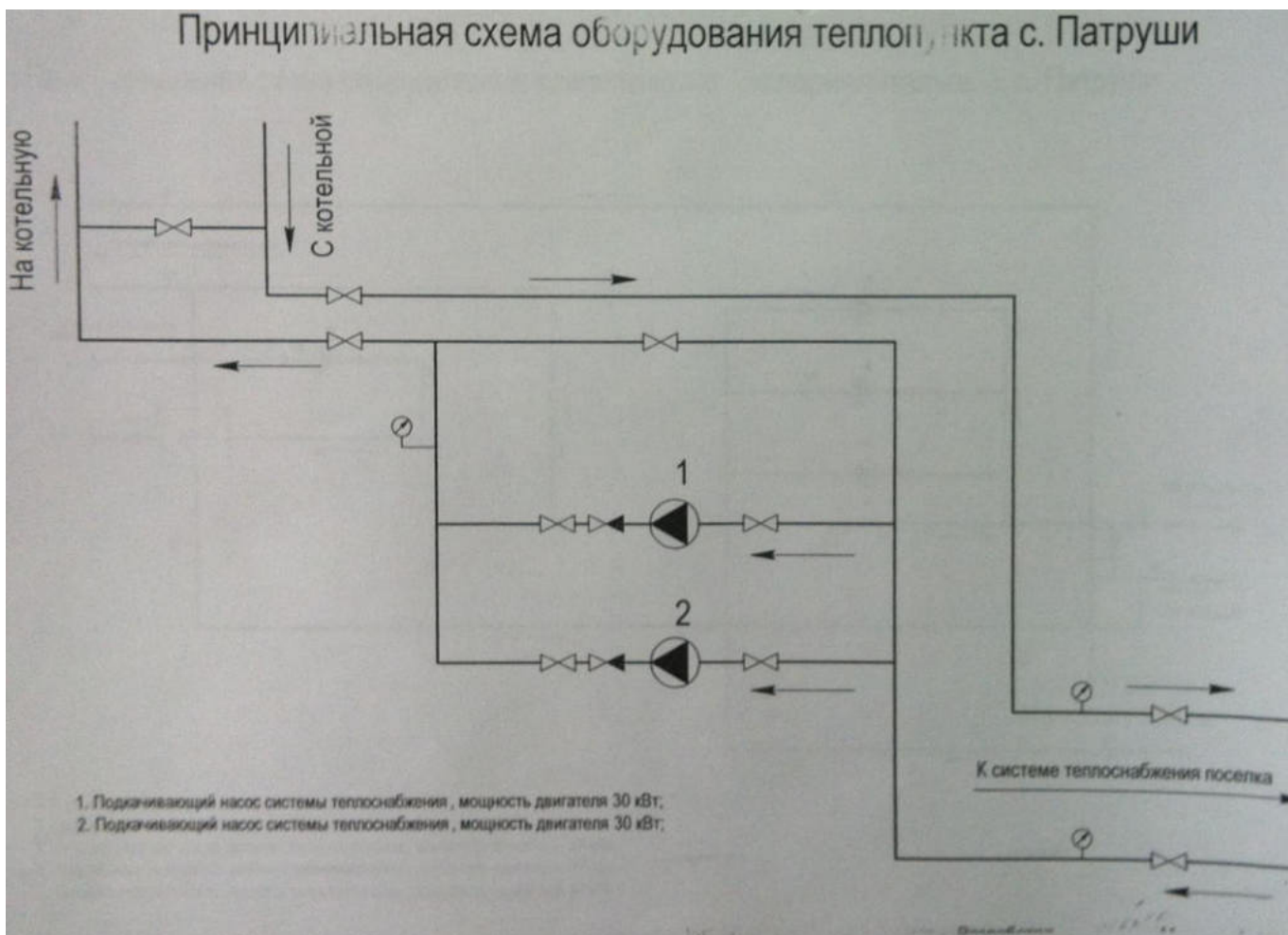
Рис.2.16. Принципиальная схема ЦТП с. Патруши.
